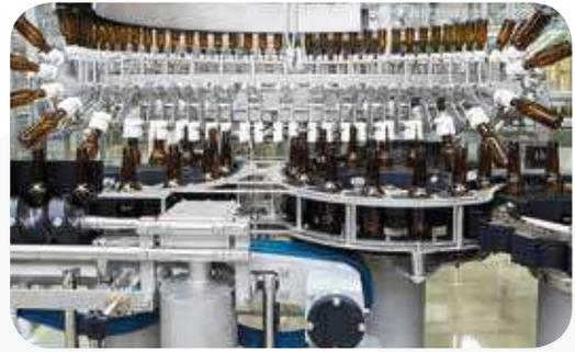
En option, le cycle de rinçage ajustable via une commande électronique, permet une optimisation du processus ainsi qu'une flexibilité plus importante. En outre, différentes solutions de rinçage et de stérilisation peuvent être utilisées pour obtenir les résultats adaptés aux différents produits de remplissage (par exemple, la désinfection à l'eau stérile, l'air stérile, une solution d'alcool, de l'azote, de l'acide sulfurique,...).
