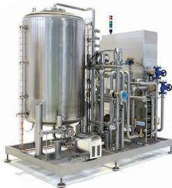
Le VISIMIX est idéal pour la production d'eau gazéifiée, de cola ou de limonade. La désaération de l'eau est effectuée par des buses de pulvérisation d'eau dans la cuve à vide. Ensuite, le flux d'eau est dirigé vers la cuve de carbonatation puis la zone de mélange du sirop. Le débit d'eau est asservi à la régulation du sirop, calibrée par la recette du produit. En option, un capteur de Brix fournit en temps réel la valeur de concentration du sirop.
