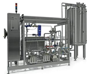
L'unité flash pasteurisation et un réservoir sont combinés dans un système pour assurer le contrôle du processus de pasteurisation. Le système est conçu pour réguler la température du produit en fonction d'un niveau d'UP défini. Le débit principal est calibré pour maintenir le produit à la température prévue pendant 30 secondes.
