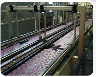
Ein Förderer von bewährter Beständigkeit, optimal geeignet für den Materialfluss schwerer Fördergüter (Kartons, Packs, Getränkekisten usw.)
